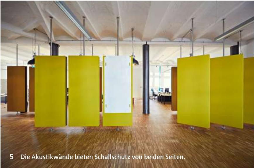
5 Die Akustikwände bieten Schallschutz von beiden Seiten.
